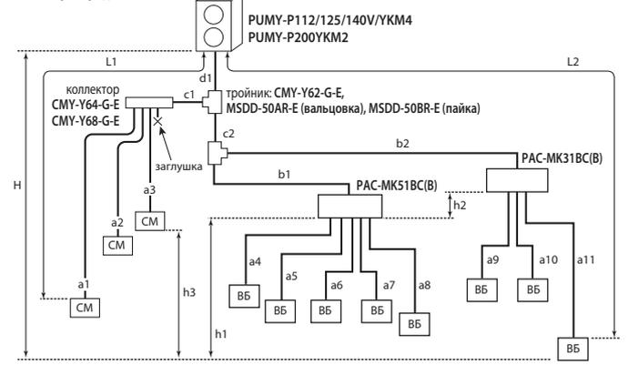
$d1 + c1 + c2 + b1 + b2 + a1 + a2 + a3 + a4 + a5 + a6 + a7 + a8 + a9 + a10 + a11 \leq 240$  м (P200:  $\leq 150$  м)
