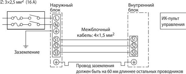
Провод заземления должен быть на 60 мм длиннее остальных проводников
