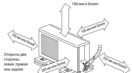
Если блок устанавливается на раме, то ее высота должна в 2 раза превышать максимальную высоту снежного покрова.
