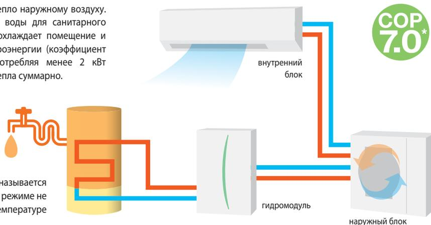
\* Параметры системы «воздух-воздух» измерены при следующих значениях температуры: в помещении — 27°C (сухой терм.)/19°C (влажный терм.), снаружи — 35°C (сухой терм.). Температура воды — 45°C.
